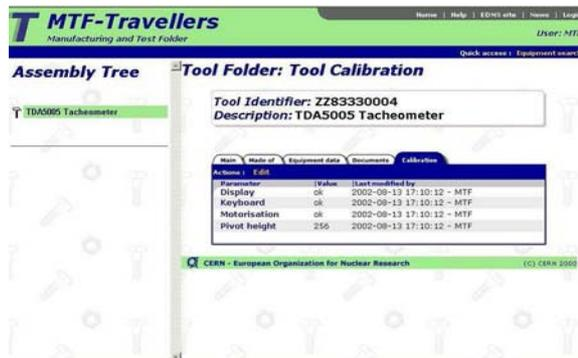
Fig. 4. The calibrations tab
